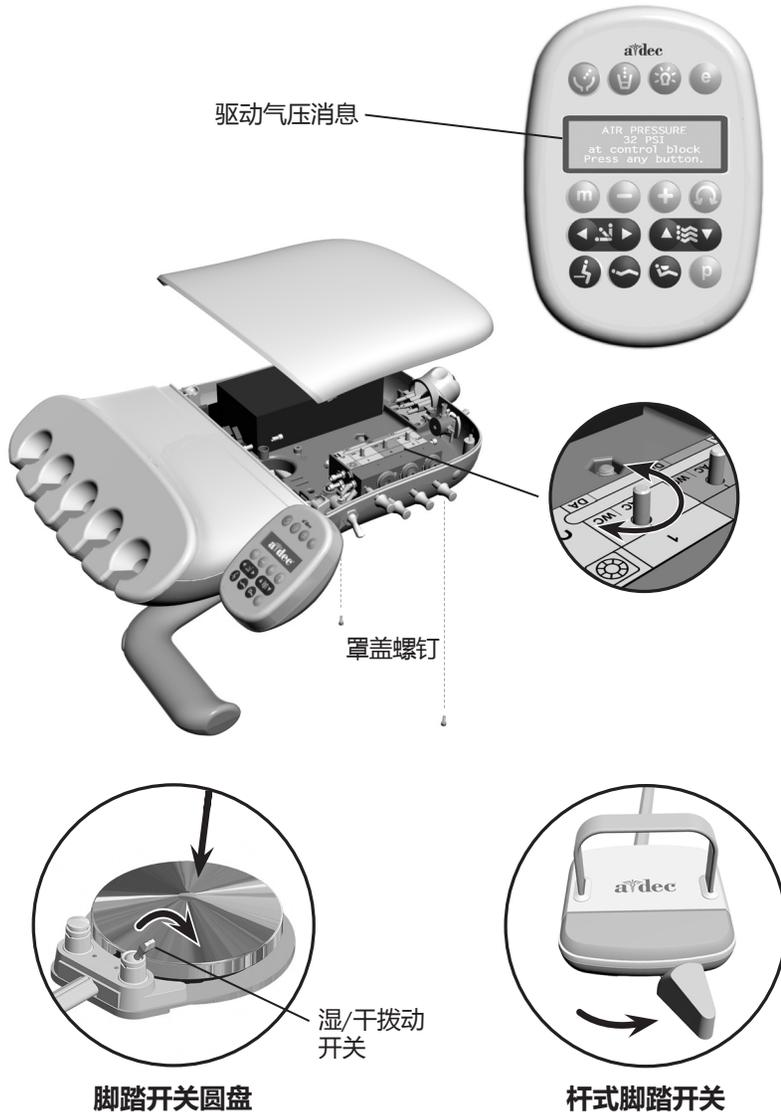
可以同时按下加号(+)和减号(-)按钮来检查豪华触控板显示屏上的驱动气压。对于带有标准触控板的牙科治疗台，为了获得最准确的驱动气测量结果，可以将牙科手机压力计（A-dec零件编号50.0271.06）连接至牙科手机软管。
