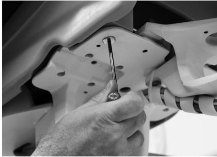
3. 在治疗椅铸件的下方，使用3/4英寸扳手松开松紧度调节螺钉一端的防松螺母。
