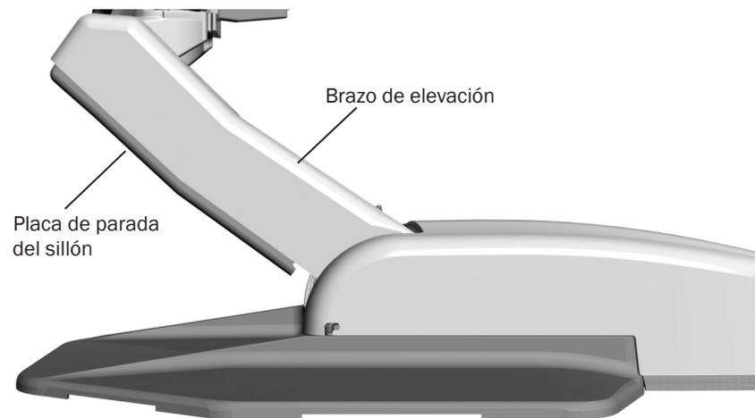
Si algo se aloja bajo el brazo de elevación del sillón o el brazo del asistente, un control de límite detiene el movimiento hacia abajo del sillón. Al presionar la placa de parada del sillón se activan los interruptores de límite. Utilice el pedal de pie o el panel táctil para elevar el sillón, luego retire el objeto.
