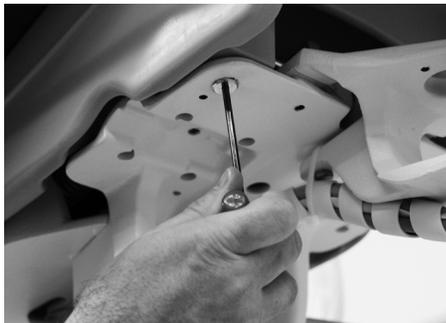
3. Debajo del armazón del sillón, utilice una llave de 3/4 pulg. para aflojar la contratuerca del extremo del tornillo de ajuste de tensión.
