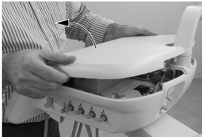
**3** Entfernen Sie die vordere Abdeckung vom Steuerkopf.
